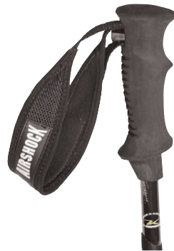
GRIFFIG Männer-Stockgriff aus EVA-Schaumstoff mit handkühlenden Riffeln und innen robust, außen dampfdurchlässig gepolsterte Schlaufe mit Fixierung der Längenverstellung durch einen Keil (KOMPERDELL Carbon Airshock M)
